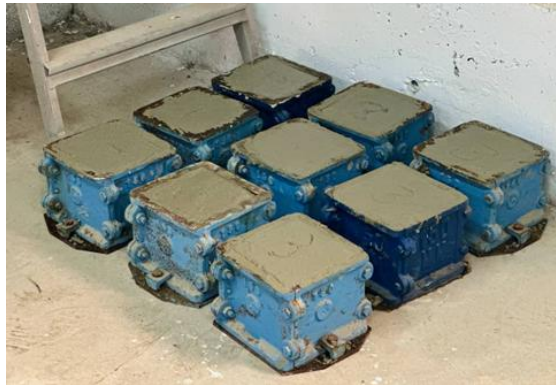
الشكل (4): صب عينات الخرسانة
